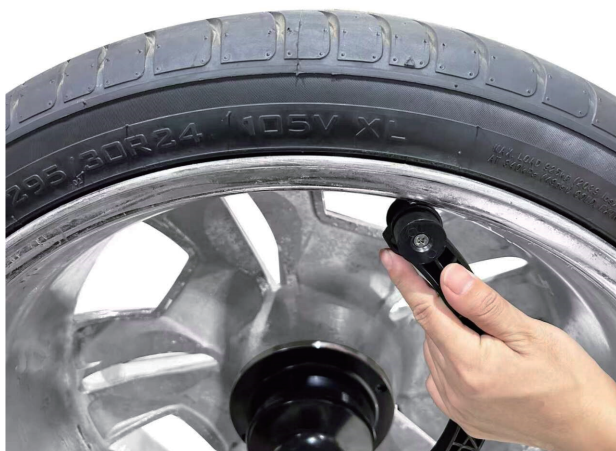
ALU-S 平衡模式 (自动拉尺测量臂安装平衡块)
